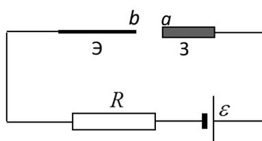
**Ф4.** Для получения дугового разряда на постоянном токе при электросварке применяется электрическая цепь, показанная на рисунке. Электрическая дуга горит на промежутке  $a-b$  между электродом (Э) и металлической заготовкой (3), включенной в цепь. Вольтамперную характеристику дуги (зависимость
